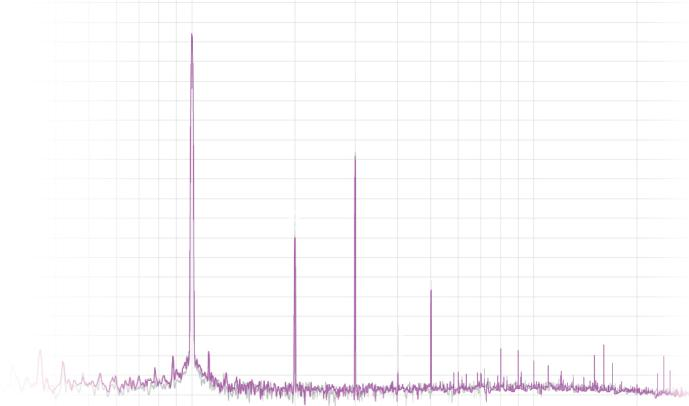
La saturación lograda con el modo “**IRON**” resalta los armónicos impares para imitar un color de transformador o cinta magnética. Si se desea ganar loudness, este modo sería el más funcional.
