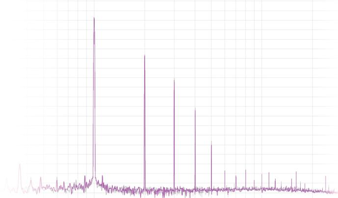
La saturación con el modo “**TUBE**” resalta los armónicos pares para imitar un color de tubo (Triodo).
